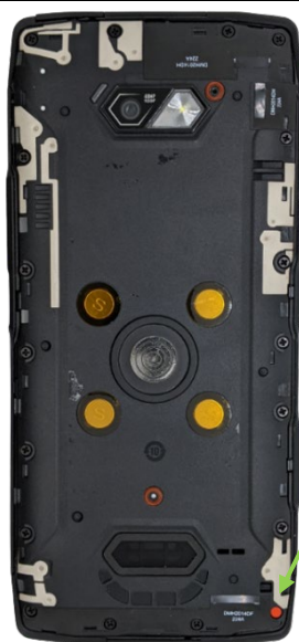
Pastille de violation
