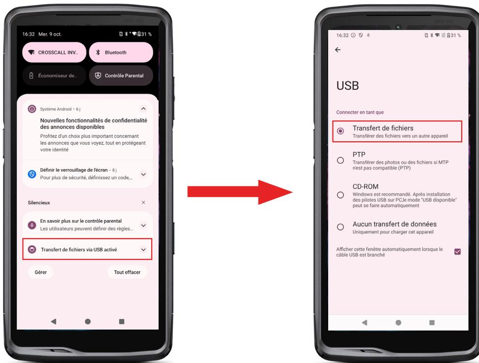
1. Quando liga o seu telemóvel ao seu computador com o cabo USB-C ou X-LINK™\*, surge automaticamente uma notificação na central de notificações.
