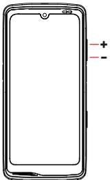
Ta gumb, sestavljen iz tipke + in tipke -, vam bo omogočil nastavitve glasnosti klicev in obvestil s preprostim preklapljanjem med tremi načini:
