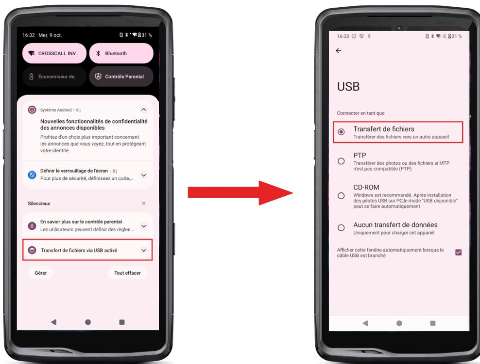
1. Quando si collega il telefono al pc con il cavo USB-C o X-LINK™\*, compare automaticamente una notifica nel centro notifiche.
