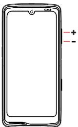
Mit dieser Taste, die aus einer + und einer - Taste besteht, können Sie die Lautstärke Ihrer Anrufe und Benachrichtigungen durch einfaches Umschalten zwischen 3 Modi konfigurieren:
