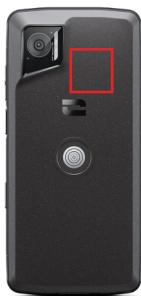
La antena NFC del STELLAR-M6E se encuentra en la parte superior derecha de la parte trasera del teléfono.
